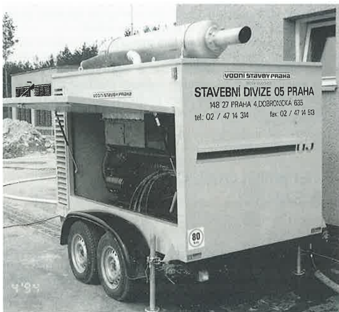
VYSOKOTLAKÝ AGREGÁT KAMAT S MAXIMÁLNÍM TLAKEM VODY NA VÝSTUPU 150 MPa
