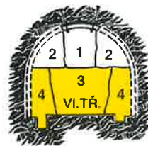
ČLENĚNÉ VÝRUBY KOTVENÍ + OCELOVÁ ŽEBRA + STŘÍK. BETON
