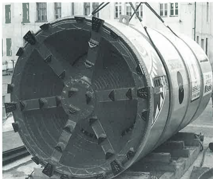
Obr. 2 UNCLEMOLE TCP 1860 – uspořádání řezné hlavy a kuželového drtiče s excentrickým usazením
