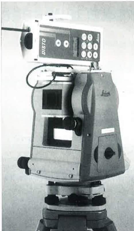
Obr. 7: Theodolit LEICA T 460D v kombinaci s laserovým dálkoměrem LEICA DISTO
