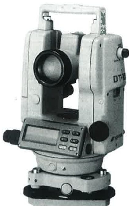
Obr. 3: Digitální laserový teodolit typ DT-110 L japonské firmy TOPCON
