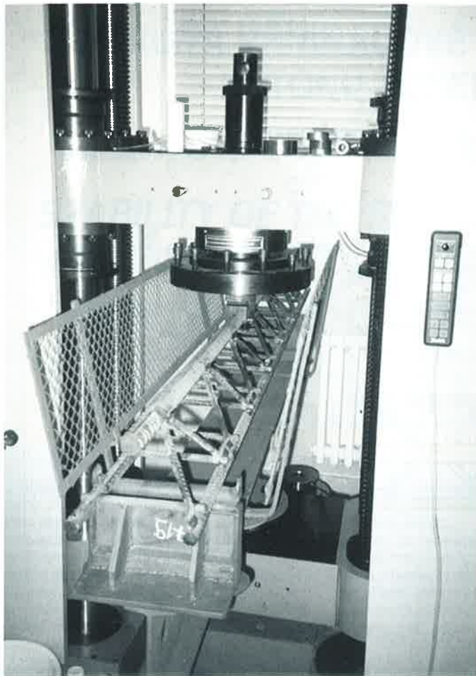
Obr. 5 Ohybová zkouška pod lisem
