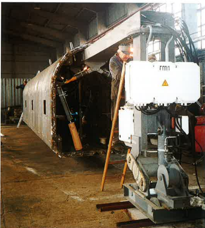
Obr. 3: Výroba oceľového teleskopického debnenia DB 2500 v dielňach Banských stavieb v Prievidzi
