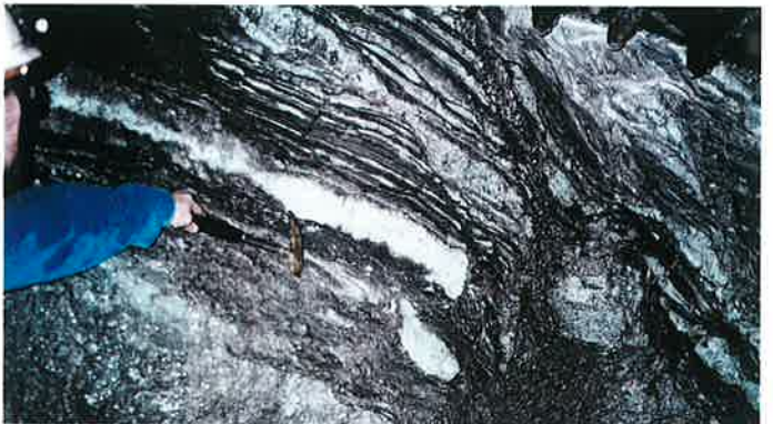
Obr. 4 Detail výrazného tektonického porušení horninového masivu. Pravděpodobně podobné jevy - poklesy, posuny, vlek a drcení existují i v pelitických a aleuritických horninách nejsou však při běžné prohlídce dostatečně kontrastní. Detail of a tectonic fault of the rock massif. Probably similar phenomena - subsidence, shifting, towing and crushing - exist in pelitic and aleuritic rocks, but they are not contrast enough on an ordinary inspection.
