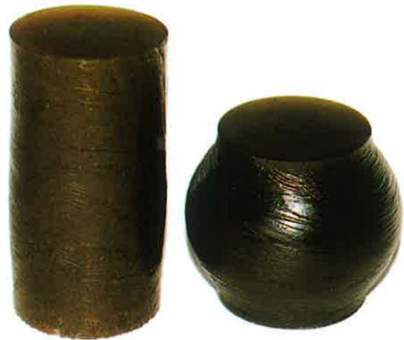
Obr. 6 Zkušební tělíska po zkoušce v prostém tlaku při poměrné axiální deformaci 10 % a 50 %. (Bevedan - Bevedol WF, koef. napěnění - 1,0) Specimens of grout Bevedan - Bevedol WF after axial deformation 10% and 50%. (factor of foaming - 1,0)
