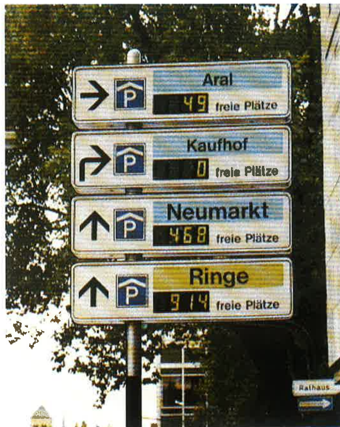
Obr. 5. Informační tabule dynamického navigačního systému na parkoviště Fig. 5. Information panel of dynamic guidance to the car parks
