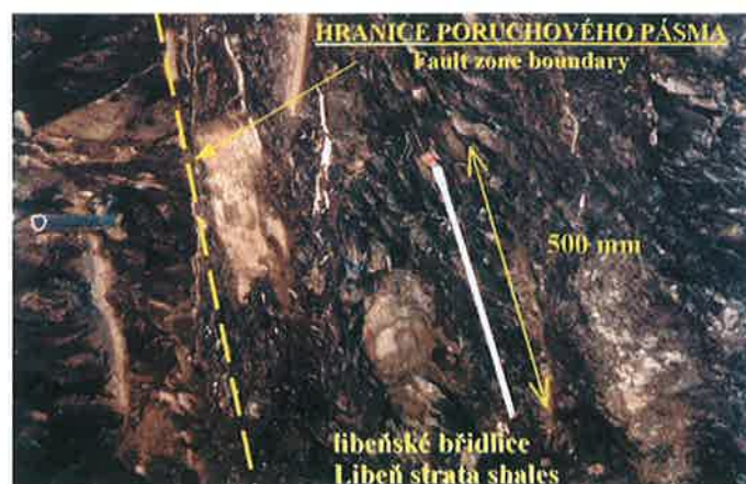
Obr. 3. Tektonicky porušené libeňské břidlice pod zástavbou v ul. Ostrovského Fig. 3. Tectonic fracturing of Libeň shale under existing buildings along Ostrovského street
