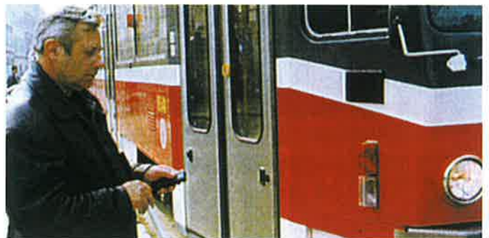
Obr. 11 a 12 Řídicí jednotka vozidla a akustické hlášení vně vozidla ovládané nevidomým Fig. 11 and 12 Vehicle controlling unit, acoustic signaling outside of the vehicle, controlled by the sightless
