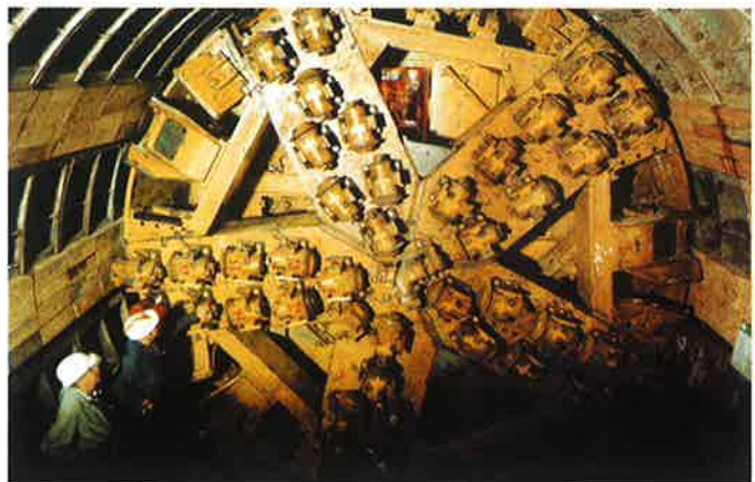
Obr. 7 Řezná hlava ruského mechanizovaného razicího komplexu nasazeného na ražbu traťových tunelů trasy A pod Vltavou (polovina 70. let minulého století) Fig. 7 The cutterhead of the Russian mechanized boring complex (TBM) utilized on running tunnels of the line A under the Vltava (the middle of the seventies of the last century)
