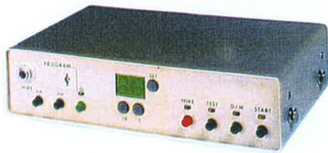
Obr. 11 a 12 Řídicí jednotka vozidla a akustické hlášení vně vozidla ovládané nevidomým Fig. 11 and 12 Vehicle controlling unit, acoustic signaling outside of the vehicle, controlled by the sightless
