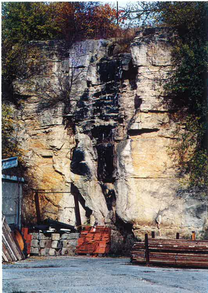
Foto 1 Kvádřové cenomanské pískovce - gt typ KCP (výchoz v Kobyliších) Picture 1 Thick-bedded Cenomanian sandstones - KCP gt type (the outcrop in Kobylišy)
