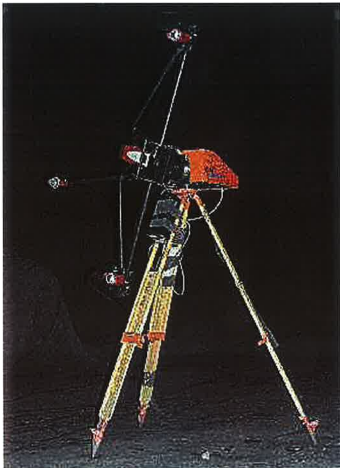
Obr. 1 DIBIT-Snímkovací modul - polní počítač s kamerou, rámem a stativem Fig. 1 DIBIT-Recording module - field computer with camera frame on tripod
