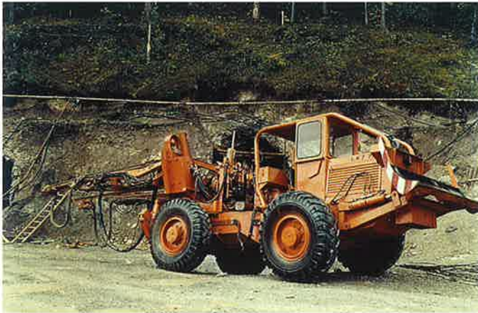
Obr. 5 Vŕtací voz na podvozku lesného kolesového traktora Fig. 5 Drilling rig on a forest wheeled tractor undercarriage
