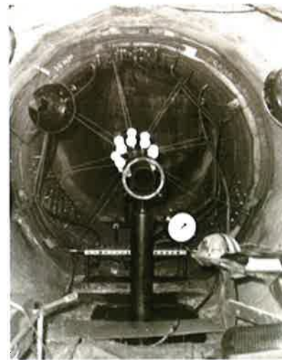
Obr. 2 Tlaková zkouška s plochými lisami ve štolě Černý Váh (1969)
