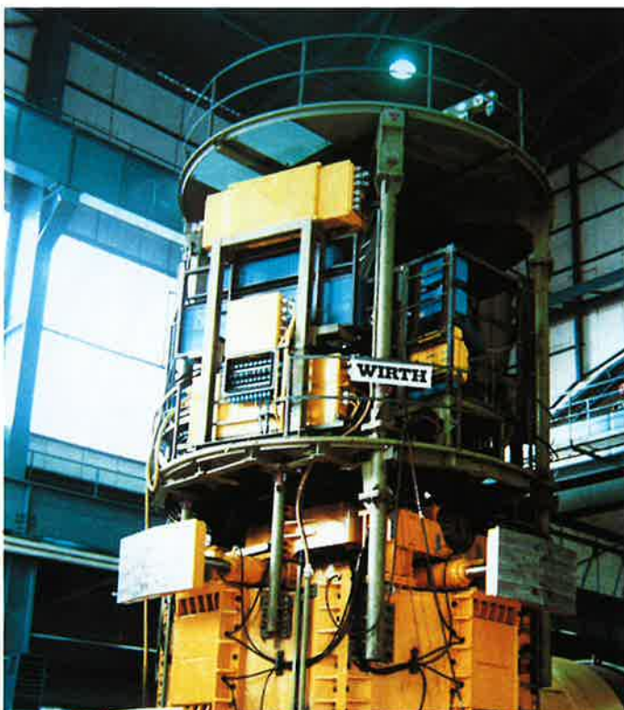
Obr. 3 Hloubicí stroj VSB firmy WIRTH Fig. 3 WIRTH VSB raise bore drill rig
