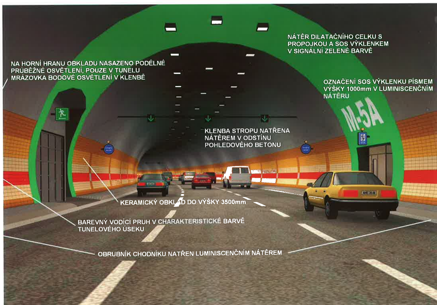
Obr. 1 Návrh definitivního uspořádání tunelu Špejchar - Pelc Tyrolka (J. Dvořák) Fig. 1 Design of final arrangement of the Špejchar - Pelc Tyrolka tunnel (J. Dvořák)
