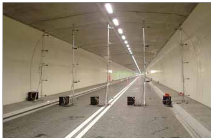
Obr. 5 Měřicí síť v dopravním prostoru
