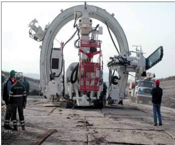
Obr. 3 Čelní pohled na smontovaný vrubovací stroj Perforex Fig. 3 Front view of the assembled Perforex prevault tunnelling machine
