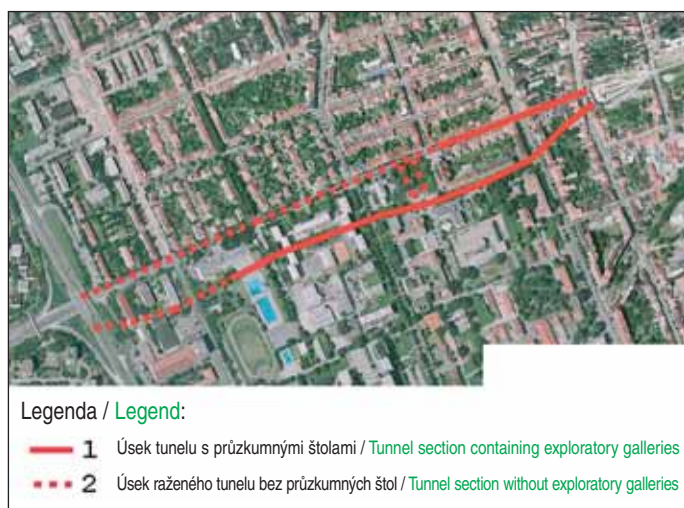
Obr. 2 Umístění tunelů v městské zástavbě
