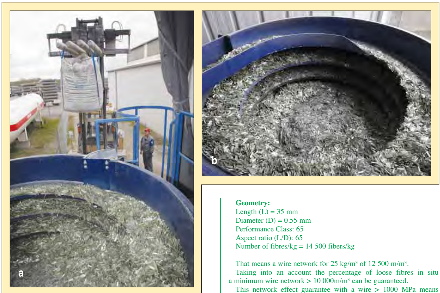
Obr. 5 a, b Dávkovacie zariadenie pre výstuž DRAMIX® Fig. 5 a, b Dosing equipment for DRAMIX® fibres
