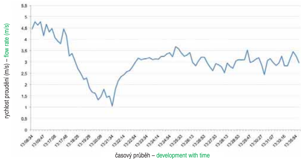
Graf 1 Graf závislosti proudění vzduchu v tunelu na časovém průběhu (zdroj: Protokol zkoušek tunelu SOKP 513 – materiál firmy K. B. K. fire, s. r. o.)
