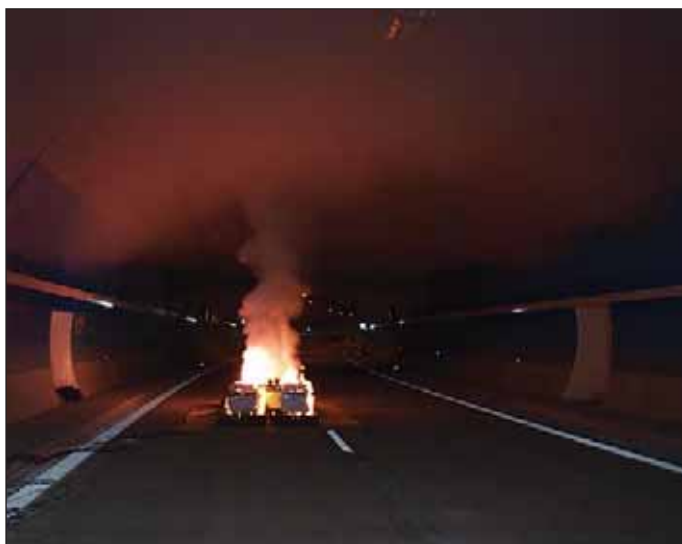
Obr. 5 Stratifikace aerosolu při proudění vzduchu 0,6–0,8 m/s (foto Ing. Petr Beběčák, Ph.D.)
