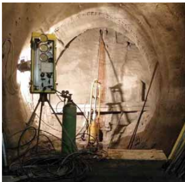
Obr. 7 Provádění doplňujícího geotechnického průzkumu pomocí presiometrických zkoušek v průzkumných vrtech. Vpravo převrtný diagram – vyhodnocení presiometrické zkoušky
