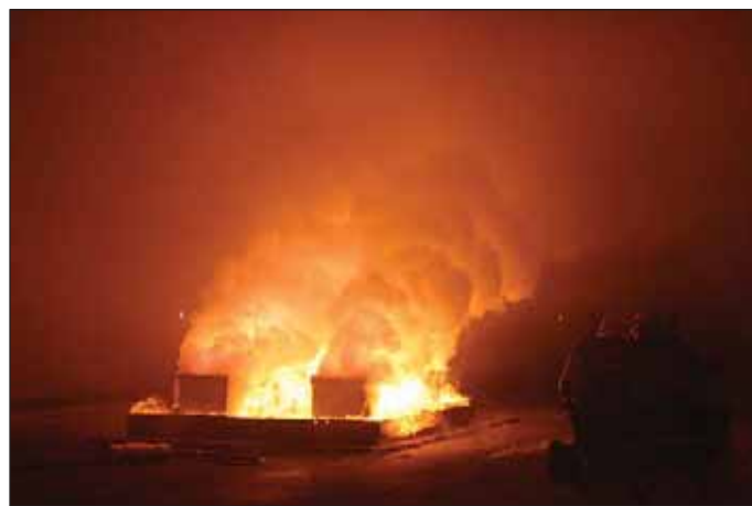
Obr. 3 Vývin zkušebního aerosolu při plně rozvinutém požáru (foto Ing. Petr Bečák, Ph.D.)
