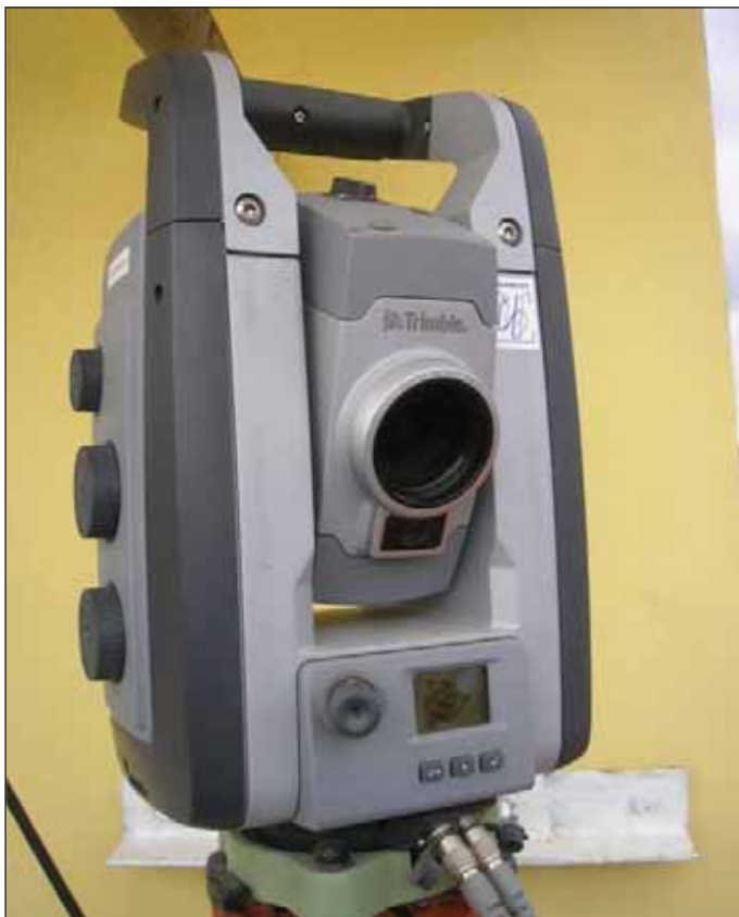
Obr. 4 Totální stanice Trimble S8 Fig. 4 Total station Trimble S8
