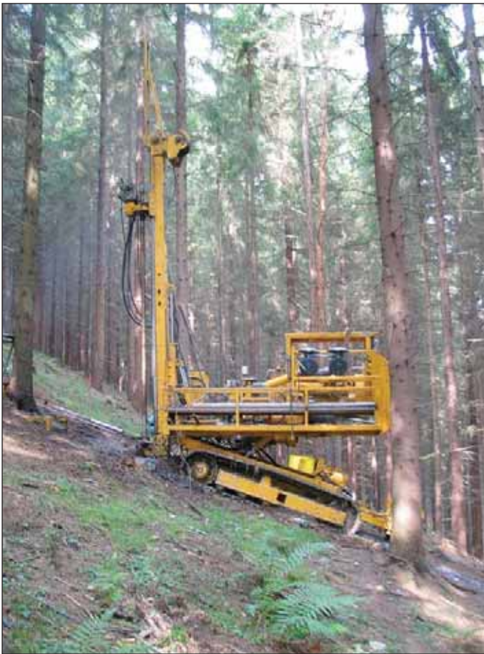
Obr. 5 Geotechnický průzkum pro tunely vyžaduje náročnou technologii. Na obrázku jádrová samohybná souprava v obtížném terénu umožňující kontinuální jádrové vrtání s průběžným odběrem neporušených vzorků hornin až do hloubky 200 m (Čebraď, D-1, – Foto Matejček- Geofos)
