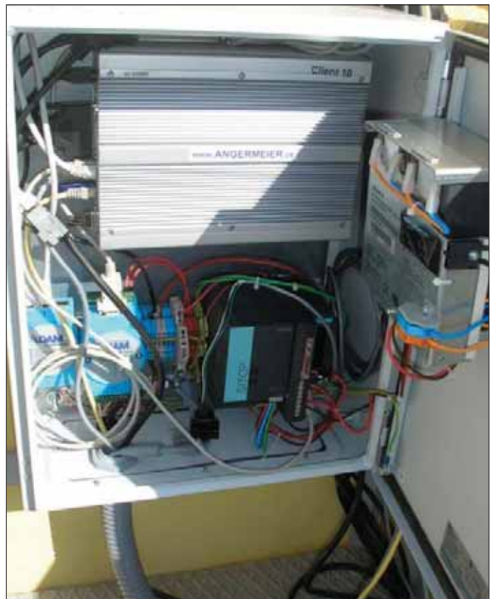
Obr. 5 Observerbox – průmyslový počítač s doplňky Fig. 5 Observerbox – industrial computer with accessories
