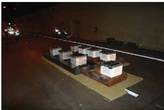
Obr. 2 Vytváječe aerosolu před zkouškou (foto Ing. Petr Bečák, Ph.D.) Fig. 2 Aerosol producers before testing (photo courtesy of Petr Bečák)
