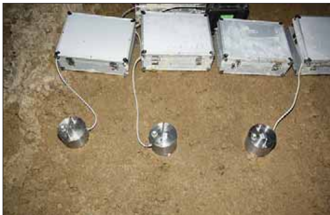
Obr. 2 Senzory ViGeo na počvě tunelu Olbramovice (Kukutsch) Fig. 2 ViGeo sensors on the Olbramovice tunnel bottom (Kukutsch)
