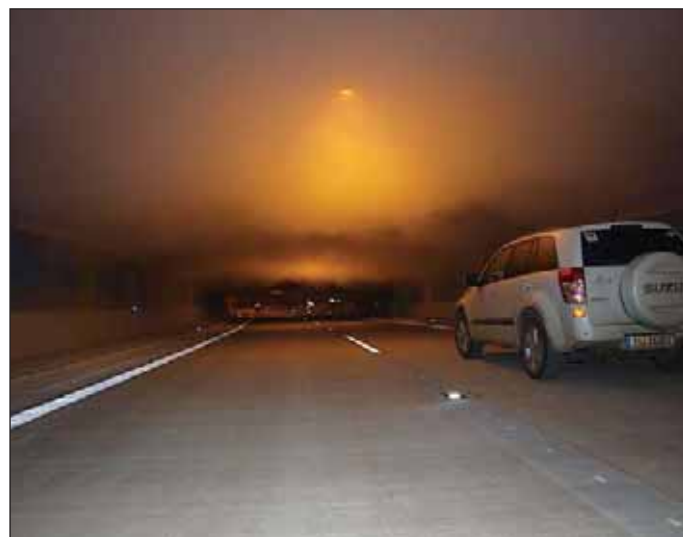
Obr. 6 Stratifikace aerosolu ve vzdálenosti 100 m od simulovaného požáru (foto Ing. Petr Beběčák, Ph.D.)
