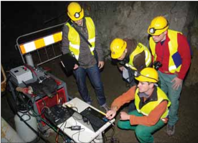
Obr. 7 Sestava pro měření plynopropustnosti hornin (Vojta Hrach) Fig. 7 Gas permeability of ground measuring set (Vojta Hrach)
