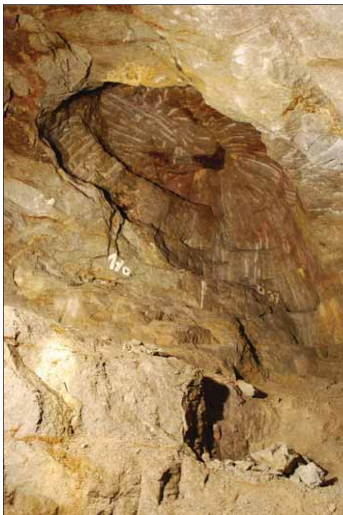
Obr. 3 Ukázka dovrchního dobývání (komora K1); foto Lednická Fig. 3 Example of ascending working (chamber K1); Photo courtesy of Lednická
