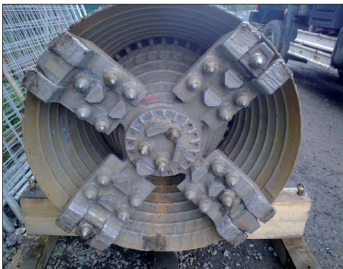
Obr. 2 Hlava stroje po úpravě Fig. 2 Cutterhead after modification
