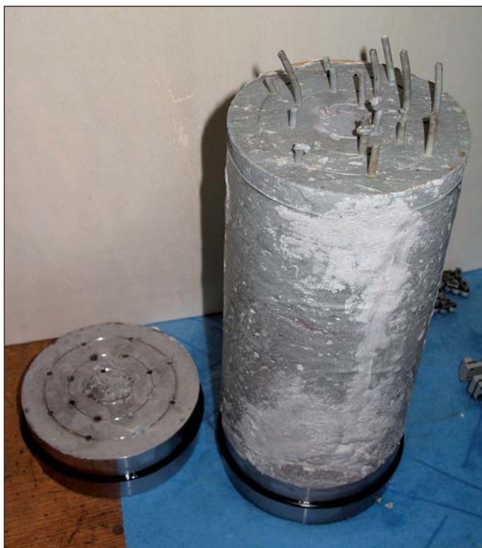
Obr. 5 Trojosý vzorek vysoce plastické, jemnozrnné výplně tektonické poruchy: vzorek proniká drenážními otvory v horní destičce a vytváří přívěsky podobné špagetám (po zkoušce se zkušební vybavení upravilo; foto M. Blümel) Fig. 5 Triaxial test sample of highly plastic, fine grained fault gouge: sample entering drainage holes in the top plate forming spaghetti-like appendices (testing equipment was modified after test; photo: M. Blümel)
