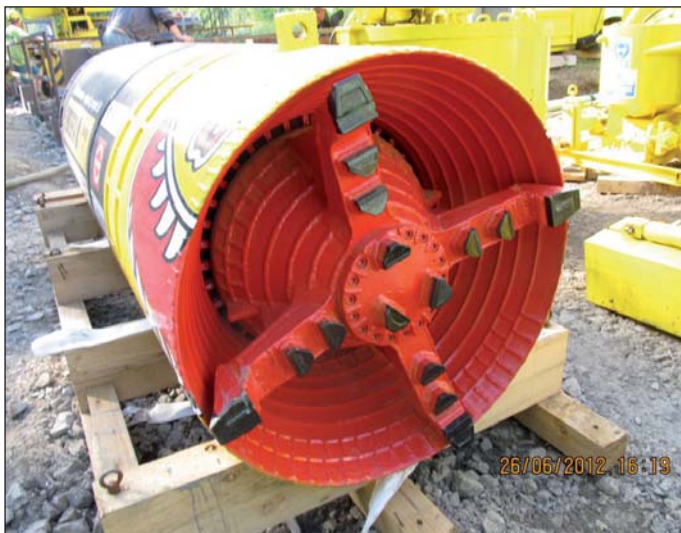
Obr. 1 Hlava stroje před úpravou Fig. 1 Cutterhead before modification
