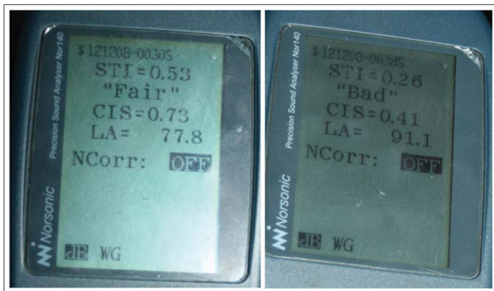
Obr. 5 Hodnoty STI na displeji měřicího přístroje při měření nově navrženého (vlevo) a stávajícího (vpravo) nouzového zvukového systému při vypnutých ventilátorech
