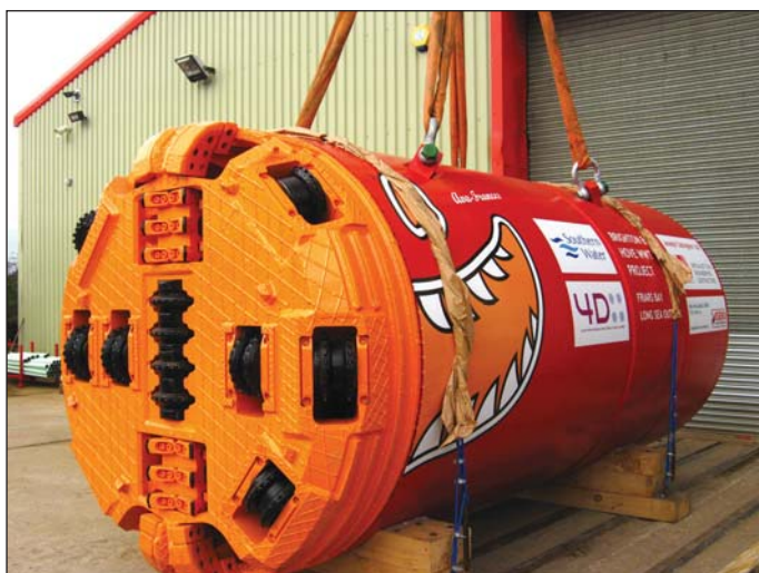
Obr. 2 Razicí hlava do skalních hornin Fig. 2 Rock boring cutterhead
