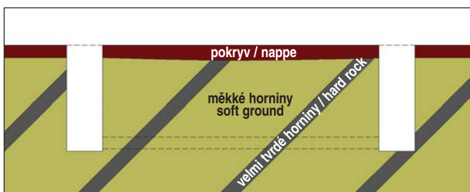
Obr. 6 Místní výskyt extrémně pevných hornin Fig. 6 Local occurrence of extremely hard rock
