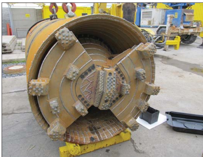
Obr. 1 Razicí hlava do poloskalních hornin Fig. 1 Weak rock boring cutterhead
