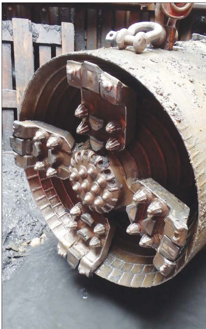
Obr. 9 MTBM TCC ① po dokončení ražby Fig. 9 MTBM TCC ① after the completion of excavation
