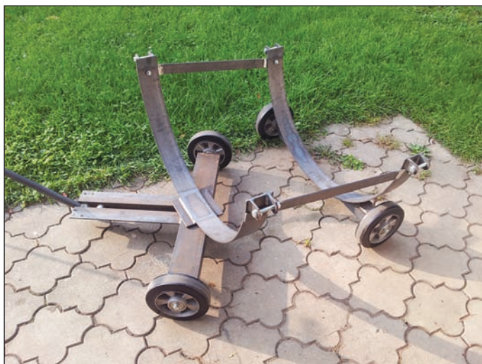
Obr. 16 Zavázeční vozík připraven k přepravě bez trubek – Dolní Počernice Fig. 16 Transportation carrier prepared for transportation without tubes – Dolní Počernice
