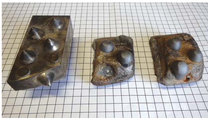
Obr. 10 Obroušená boční obvodová řezná dláta Fig. 10 Ground-down peripheral cutters
