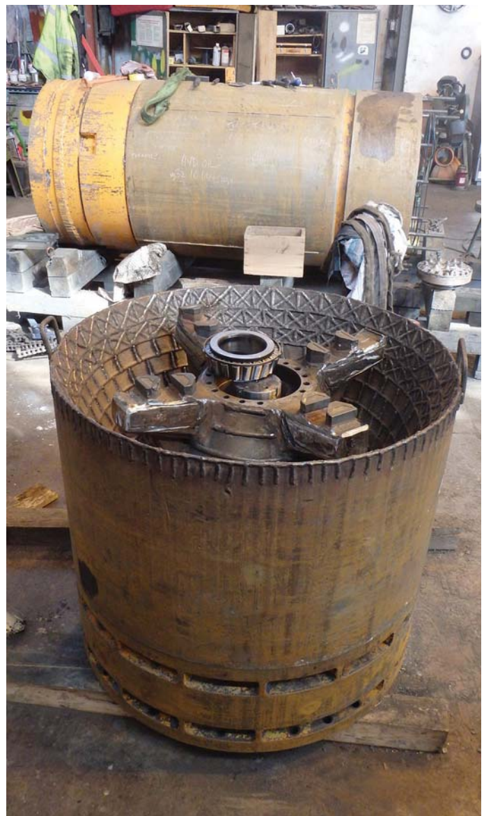
Obr. 11 Oprava řezné hlavy ①
