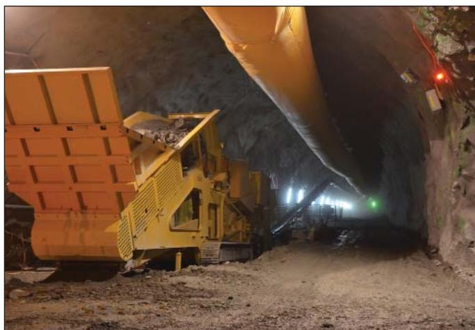
Obr. 7 Pohľad na drvič s pásovým dopravníkom umiestnený v tunelovej rúre B
