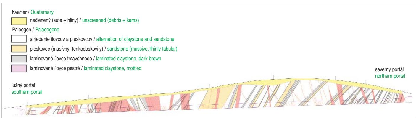
Obr. 2 Pozdĺžny inžinierskogeologický rez v osi tunela Laliki
