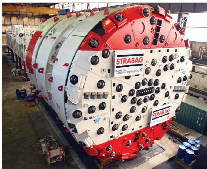
Obr. 4 TBM do skalních hornin s dvojitým štítem od společnosti Aker-Wirth
