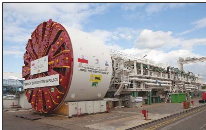
Obr. 5 Sestavený bentonitový štít S-745 při předání v továrně Herrenknecht Fig. 5 Assembled slurry pressure balance TBM S-745 being handed over in Herrenknecht factory
