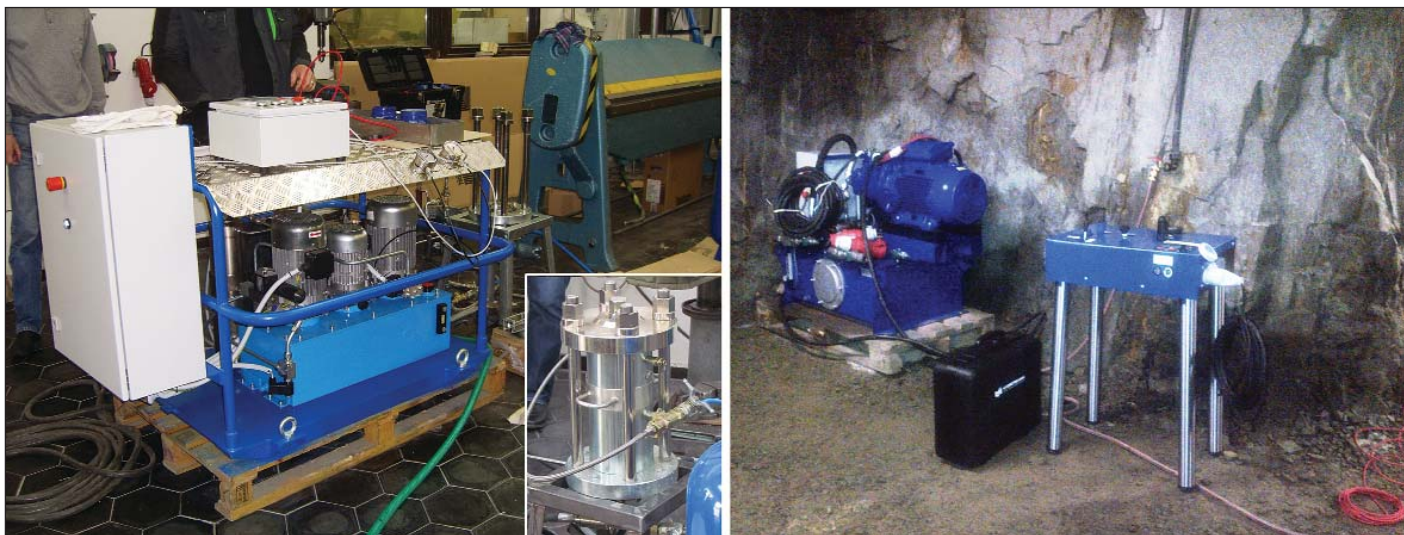
Obr. 1 Zařízení použité pro testování mikrovzorků a makrovzorků s tlakovou komorou pro usazení mikrovzorku (vlevo) a zařízení použité pro testování in-situ (vpravo) Fig. 1 Apparatus applied for micro and macro-sample testing with pressure chamber for the micro-sample emplacement (left) and for testing in-situ
