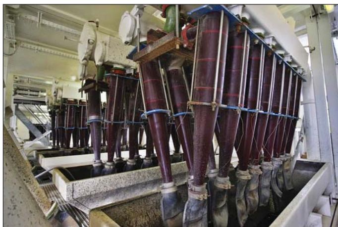
Obr. 7 Hydrocyklony v zařízení pro separaci kalů Fig. 7 Hydrocyclones in the solids separation plant
