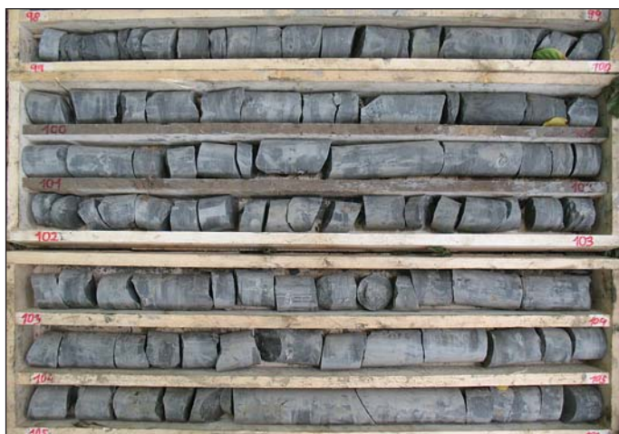
Obr. 5 Ukážka výnosu vrtného jadra ílovcových vrstiev z vrtu T-9, hĺbkový interval 98–106 m, zobrazený úsek predstavuje uspokojivú kvalitu horninového masívu
