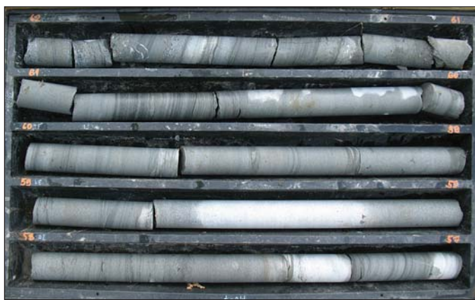
Obr. 4 Ukážka výnosu vrtného jadra pieskovcových vrstiev z vrtu T-2, hĺbkový interval 57–62 m, zobrazený úsek predstavuje dobrú kvalitu horninového masívu
