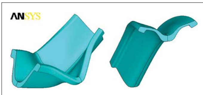
Obr. 3 Modelování deformace průřezu MKP [3]
