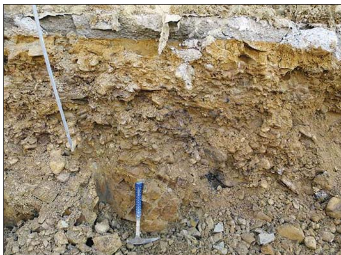
Obr. 4 Terasové písčité štěrky zastižené v oblasti západního portálu Fig. 4 Sandy terrace gravels encountered in the area of the western portal
