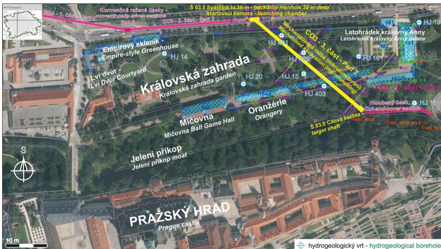
Obr. 1 Situace stoky CO3 – 3. část v ortofotomapě s vyznačenými objekty v areálu Pražského hradu
