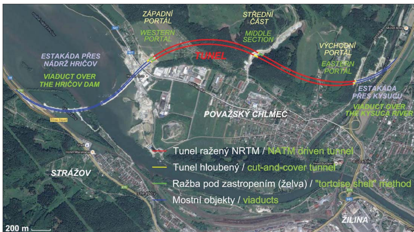
Obr. 1 Přehledná situace nového úseku dálnice D3 Žilina (Strážov) – Žilina (Brodno) Fig. 1 Layout of the new Žilina (Strážov) – Žilina (Brodno) section of the D3 motorway
