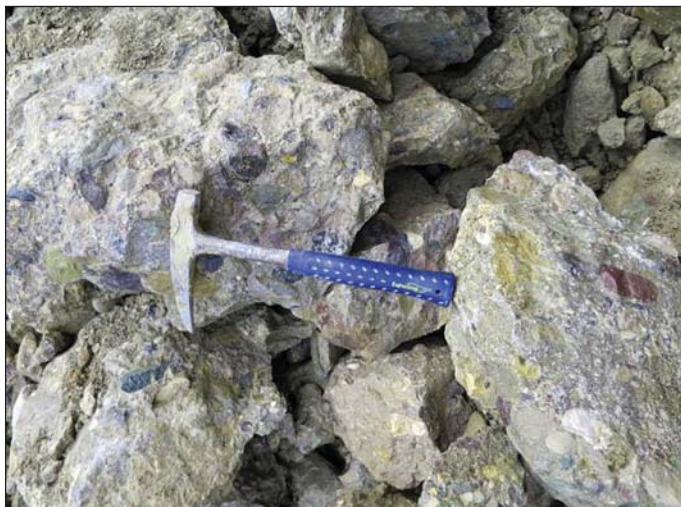
Obr. 2 Polymikttní slepence s vápnito-písčtým tmelem s vysokou pevností Fig. 2 High strength polymict conglomerates with calcareous-sandy cement
