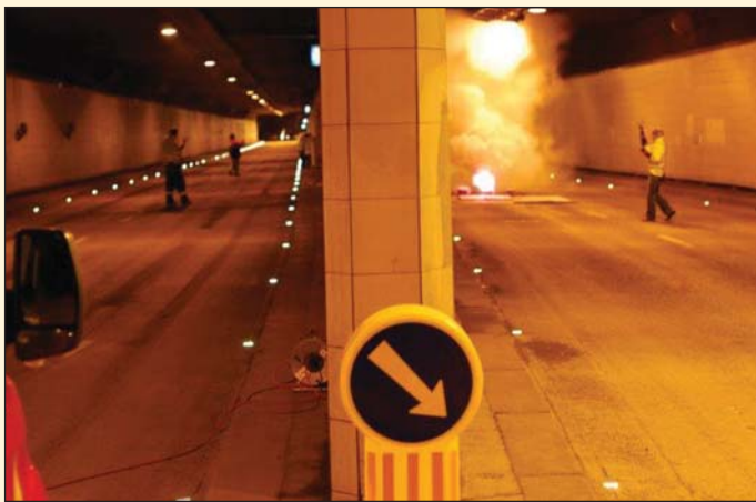
Obr. 2 Noční komplexní zkoušky před uvedením tunelu do provozu Fig. 2 Nighttime comprehensive tests prior to the tunnel opening to traffic
