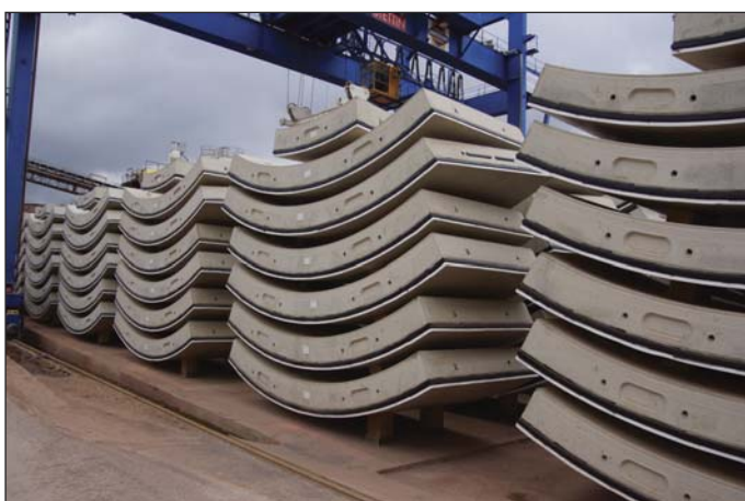
Obr. 2 Sklad dílců prefabrikovaného ostění Fig. 2 Precast lining segments stocking facility
