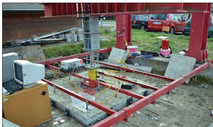
Obr. 5 Ukázka instrumentace při experimentálním měření interakce základové konstrukce s podloží
