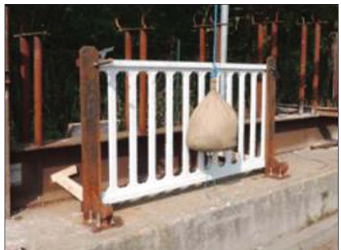
Obr. 9 Panel zábradlí při dynamické zkoušce Fig. 9 Railing panel during dynamic test
