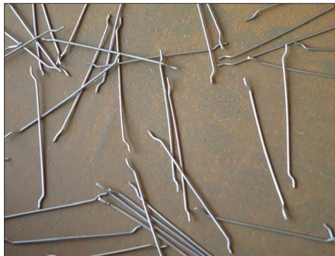
Obr. 5 Ocelové drátky Ø 1 mm, 60 mm dlouhé s jednoduchým zalomením na konci
