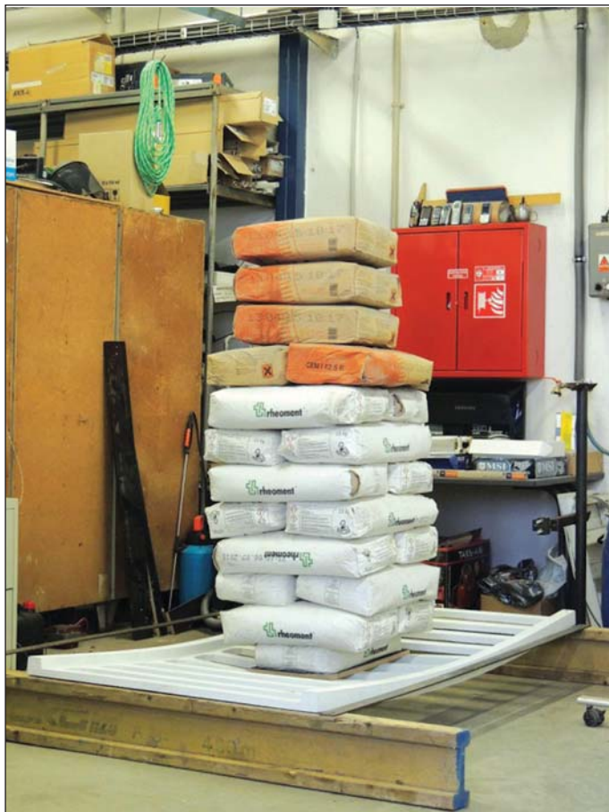
Obr. 8 Panel zábradlí při statické zkoušce 500 kg Fig. 8 Railing panel during static test 500kg
