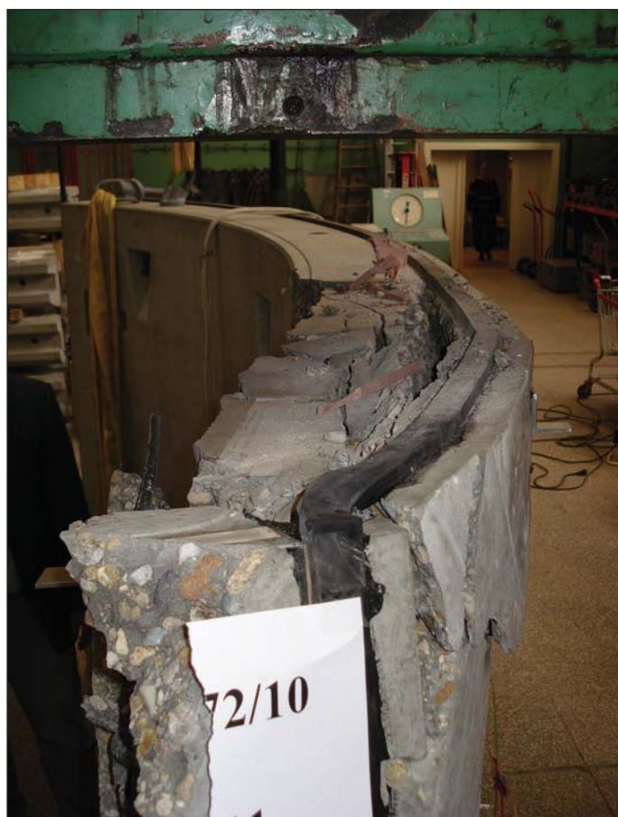
Obr. 11 Vzorek železobetonového segmentu – porušení delaminací při simulovaném zatížení tlakem válců štítu
