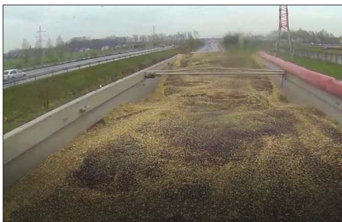
Obr. 12 Záznam z kamery instalované na návěs při odkryté plachtě – vizuální doklad o pohybu nákladu (řepky) při brzdění z 50 km/h na 0 km/h
