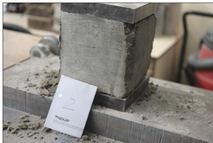
Obr. 11 Vzorek stříkaného betonu – tunel Sudoměřice Fig. 11 Specimen of sprayed concrete – the Sudoměřice tunnel
