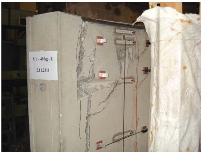
Obr. 12 Porušení drátkobetonového segmentu při simulovaném zatížení tlakem válců štítu
