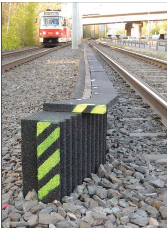
Obr. 5 Zkušební úsek s městskou protihlukovou clonou na tramvajové trati Braník – Modřany v Praze
