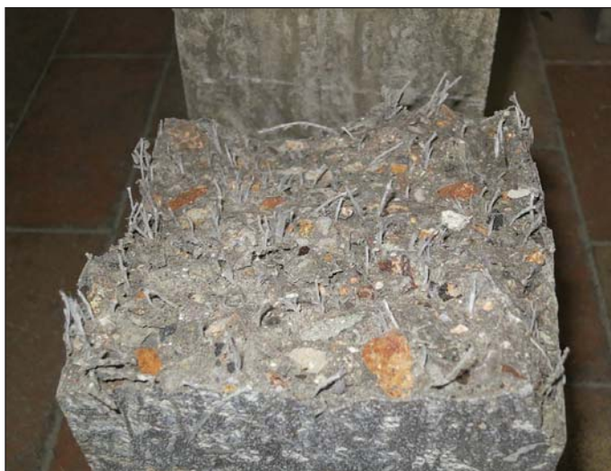
Obr. 9 Zlomek trámce po zkoušce s přetrhanými makrovláknem
