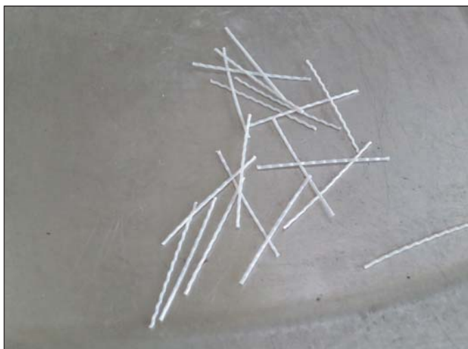
Obr. 7 Syntetická makrovlákna \varnothing 0,78 mm, délka 39 mm Fig. 7 Macro-synthetic fibres \varnothing 0.78 mm, 39mm long
