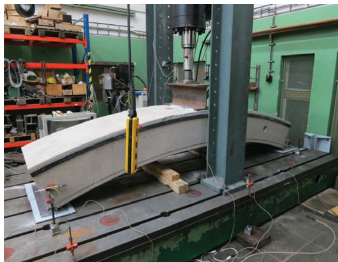
Obr. 16 Ohybová zkouška části segmentu z tunelu Ejovice
