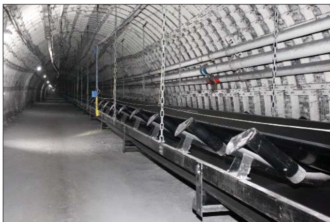
Obr. 10 Dokončený a vystrojený spojovací překop s pásovým dopravníkem HESE 1400 umožňujícím dopravovat až 2500 t těživa za hodinu
