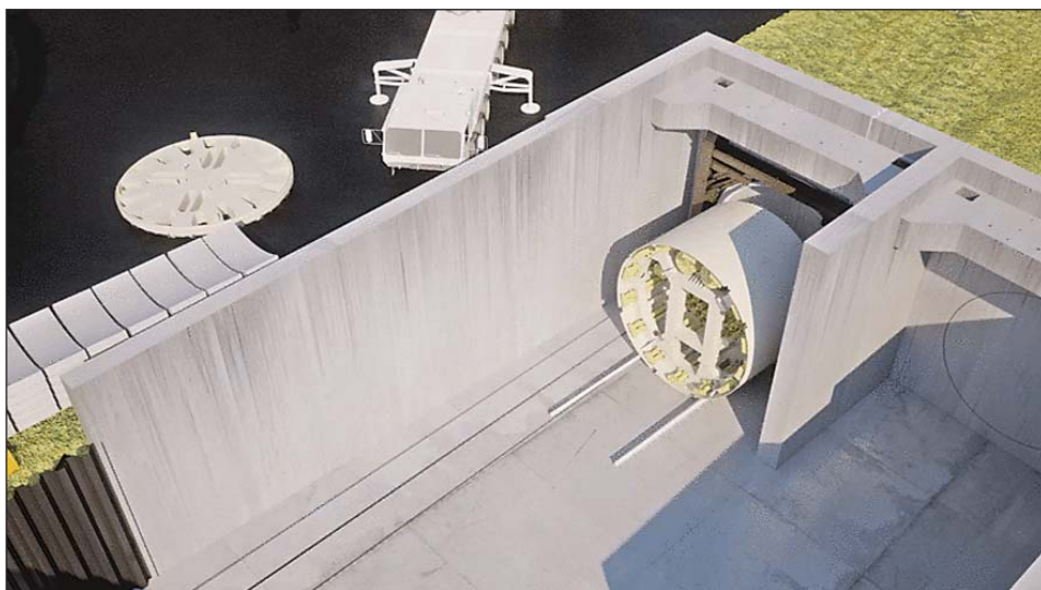
Obr. 2 Virtuální montáž razicího štítu tunelu v pilotním projektu „Tunel Rastatt“
