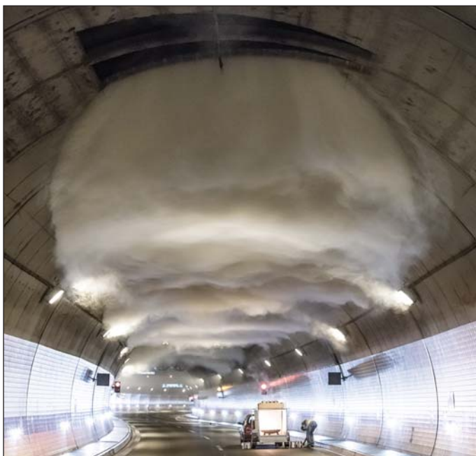
Obr. 3 Kouř nasávaný stropní štěrbinou
