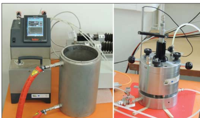
Obr. 3 Plášť triaxiální komory s regulační jednotkou pro teplotní zatěžování vzorku (vlevo) a Rowe-Barden konsolidační systém (vpravo)
