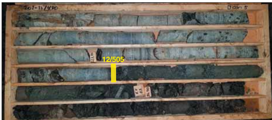
Obr. 3 Výnos jádra průzkumného vrtu provedeného v tunelu hlavní trasy HT201 s vyznačeným počátkem zhoršeného horninového prostředí
