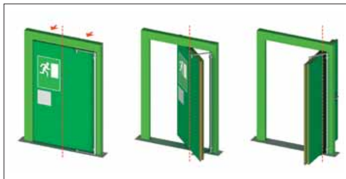
Obr. 20 Schéma principu fungování tzv. tlakově neutrálních dveří
