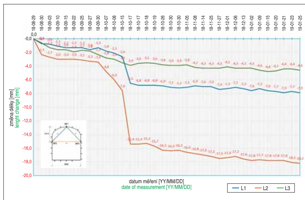
Graf 1 Průběh konvergenčních měření v tunelu BP1 ve staničení km 0,070 Graph 1 History of convergence measurements in BP1 tunnel at chainage km 0.070
