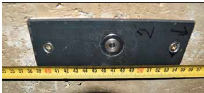
Obr. 5 Detail uchycení tlakového snímače Fig. 5 Pressure sensor mounting detail
