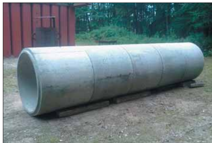
Obr. 3 Sestava skruží použitých pro experimentální měření Fig. 3 Set of rings used for experimental measurements
