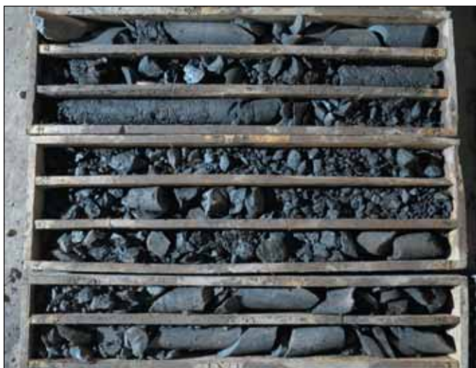
Obr. 16 Jádro vrtu ŠJ1010 zastihující mocné poruchové pásmo zastížené rovněž v průzkumné štoli OLI
