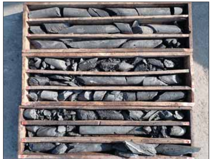
Obr. 10 Jádro vrtu PP01-J2 zastihující břidlice bohdaleckého souvrství s různým stupněm tektonického porušení
