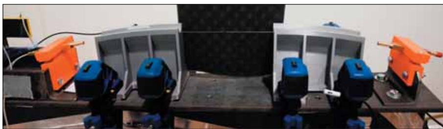
Obr. 6 Ramenáť pro laboratorní testování zakřivených snímačů deformace Fig. 6 A cradling for laboratory testing of curved sensors of deformations
