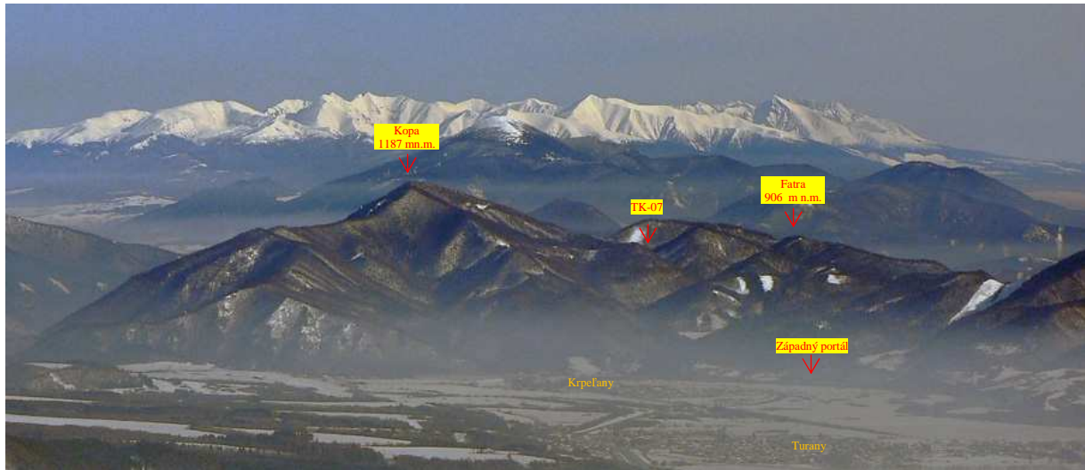
Obr.1 Pohľad na masív Kopy z Martinských hôľ. Z obrázku je zjavná generálna orientácia horninových vrstiev so sklonom k juhu (vpravo), s lokálnymi odchýlkami orientácie smerom k juhozápadu resp. k juhovýchodu. V mieste vrtu TK-07 prechádza trasa tunela. (Zdroj: http://turistika.vetroplachmagazin.sk/kralovianska-kopa-661 )
