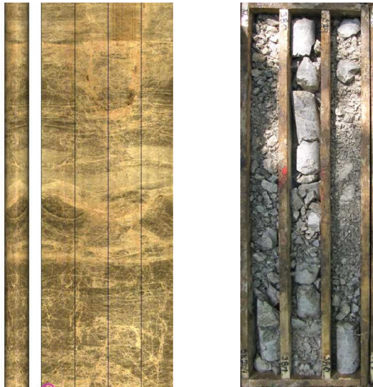
Obr. 6 Obrázok steny vrtu TK-07 v hĺbke 380 - 381 m (vľavo), získaný vrtným skenerom a charakter výnosu jadra z rovnakej hĺbky (vpravo). Napriek nízkemu výnosu a hodnote RQD, dilatometrické skúšky v tomto horninovom prostredí preukázali dobré geotechnické parametre masívu. Jadrové vrtanie v tomto prípade neumožňovalo odobrať charakteristické vzorky hornín na laboratórne rozboru a uspokojivo stanoviť porušenosť masívu.
