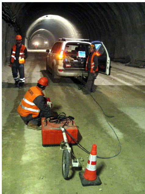
Obr. 7 Georadarové merania vykonávané v dne tunelovej rúry Fig. 7 Georadar measurements carried out on the tunnel tube bottom
