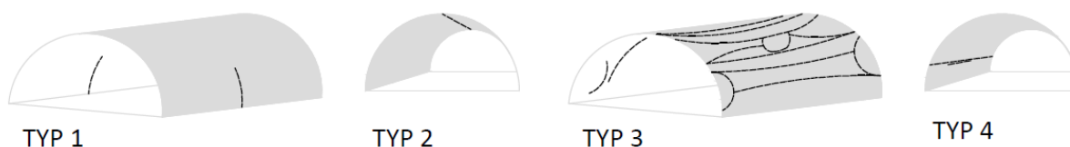
Obr. 2 Typy trhlín na nevystuženom sekundárnom ostení
