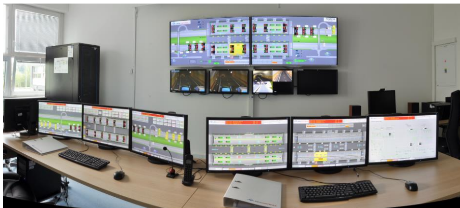
Obr. 1 Simulátor riadenia tunelov na Žilinskej univerzite v Žiline Fig. 1 Tunnel Traffic & Operation Simulator at University of Žilina
