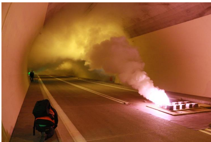
Obr. 5 Experiment v tuneli Poľana s aerosolom (studený dym) Fig. 5 Experiment in tunnel Poľana with aerosol (cold smoke)
