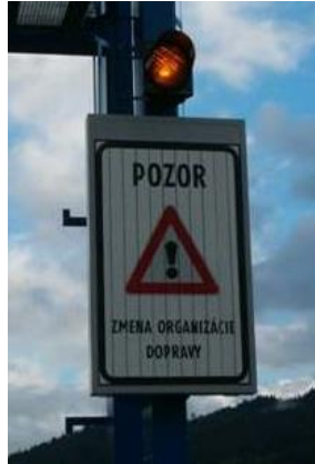
Obr. 2 Mechanické dopravné značenie s vertikálne usporiadanými lamelami Mechanical traffic sign with vertical lamellas Zdroj: Fotografia, autor: Ing. Peter Mariňák
